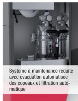
associent jusqu'à trois filtres automatiques montés en série et sont complétées par l'**évacuation automatisée des copeaux**. La boue est évacuée en continu dans le chariot à copeaux. Le système ainsi obtenu ne nécessite quasiment aucune maintenance ni aucun consommable, de sorte que l'utilisateur peut se concentrer sur la production de pièces plutôt que sur le remplacement des filtres et sur le nettoyage des réservoirs.
