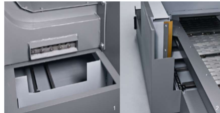
// Fig. 1 : Sortie du convoyeur de zone travail au niveau de la cuve de la machine
