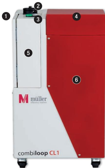
La più piccola unità ad alta pressione con tecnologia facilmente accessibile è ideale per installazioni ristrette, come sotto il mandrino. Grazie alla robusta pompa a ingranaggi e al filtro dinamico ad alte prestazioni, consente una lavorazione efficiente di ottone, acciaio, rame e bronzo, sia su torni automatici a lungo mandrino che su torni, centri di lavorazione o macchine multimandrino.
