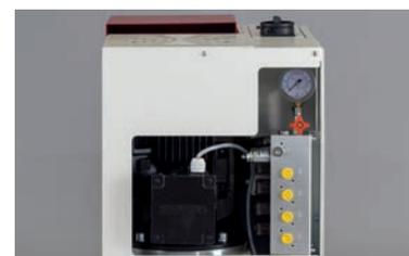
La pompa a ingranaggi con smorzamento del rumore e alloggiamento in ghisa da 70 bar consente la foratura di fori profondi, la foratura senza broccatura e molti altri vantaggi che aumentano l'efficienza di foratura, tornitura e fresatura.
